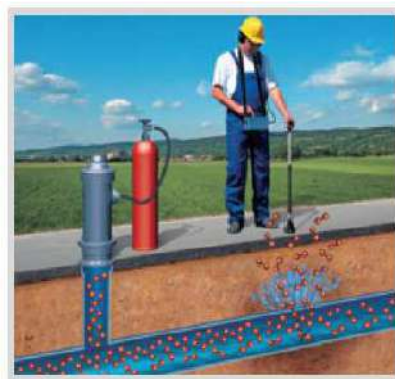
Principe de fonctionnement du gaz traqueur
