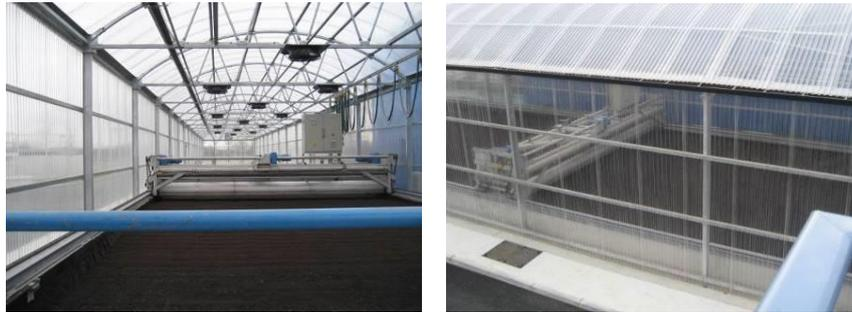
Ce procédé permet l'obtention de boues sèches pouvant atteindre des siccités de 90% stabilisées (sans odeur) et totalement ou partiellement hygiénisées dont le volume final est 3 à 5 fois moins important que le volume entrant.
